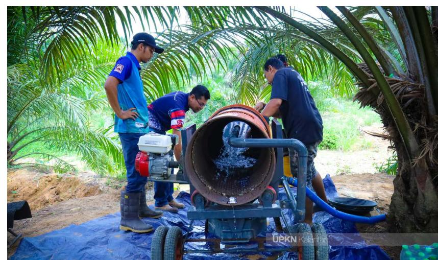
Mesin ini dilengkapi dengan penapis (sieve) yang terdiri daripada penapis besi dan karpet rumput sintetik. Mesin tersebut disambungkan dengan pam air yang menyedut dari anak sungai berhampiran bertujuan memecahkan ketulan tanah sekaligus memudahkan kerja mendulang atau mengayak emas.
